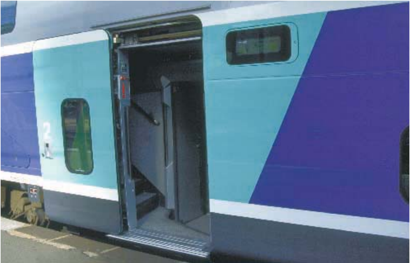
TGV Duplex : Porte louvoyante coulissante étanche aux ondes de pression TGV Duplex : Sliding plug access door (pressure tight)
