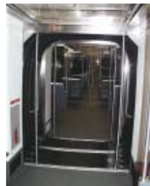
Couloir d'intercirculation du métro de Bilbao Gangway of Bilbao Metro
